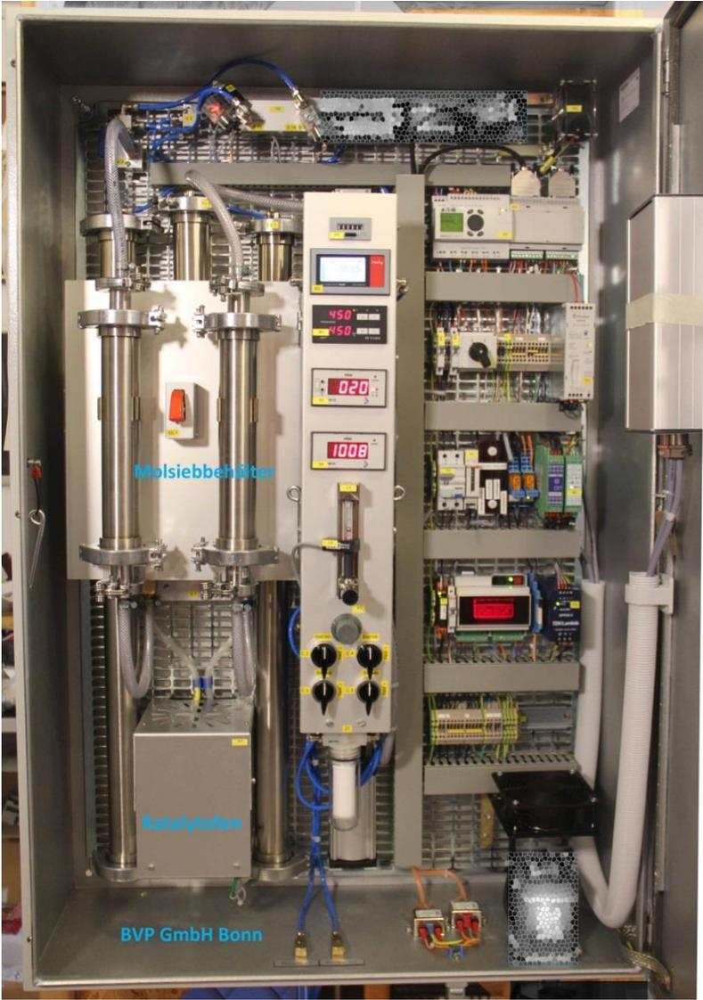
**Echantillonnage continu ( ! ) avec une pompe à piston éprouvée jusqu'à 600 mbar de dépression.**
